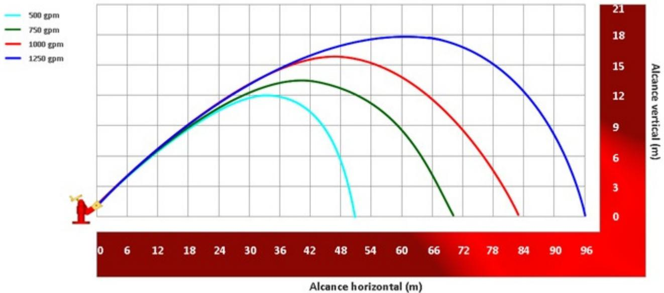
**NOTA:** Esguicho posicionado a 35° do eixo horizontal, elevação do canhão monitor 1,2 metros acima do nível do solo.
